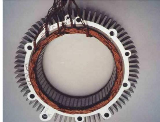
Fig. 2.b. Stator de l'ADI asynchrone
