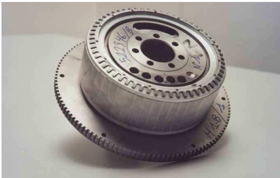
Fig. 2.a. Rotor de l'ADI asynchrone
