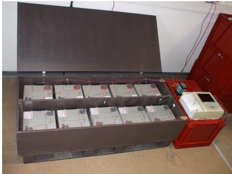
Figure 53 : Photo de l'épérience de la mesure de l'autodécharge
