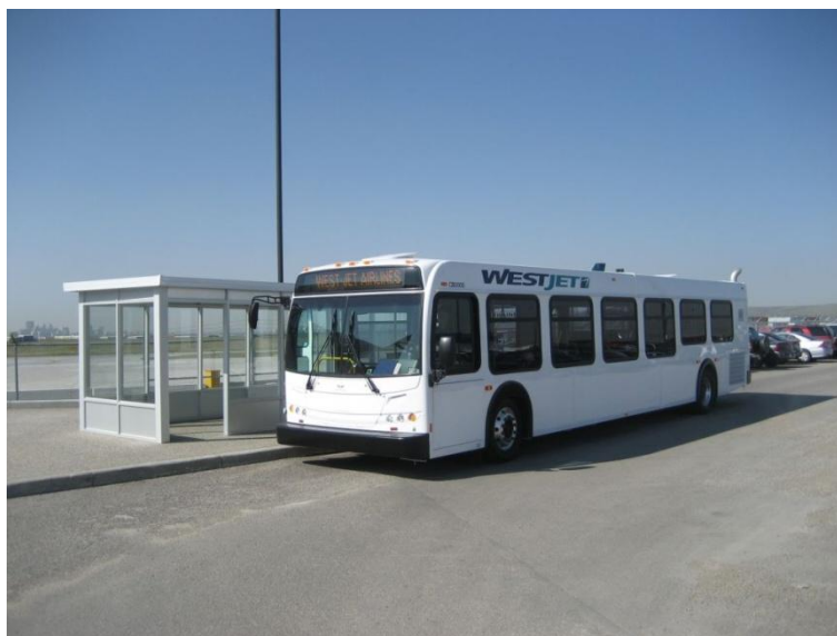
Figure 10 : Autobus hybride parallèle « New Flyer »
