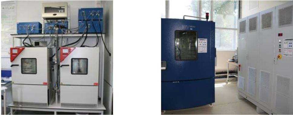
Figure 2-15. Potentiostats reliés aux amplificateurs, et deux enceintes thermiques (gauche). Enceinte thermique et armoire électrique des bancs de puissance (droite).
