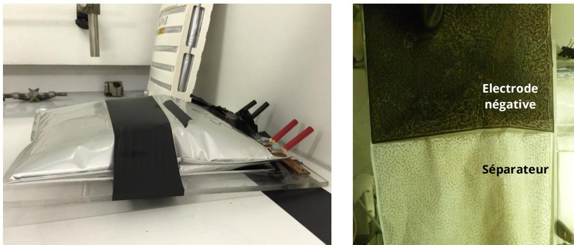
Figure 3-42. Photo de la cellule ayant considérablement gonflée (gauche) et de l'électrode négative en vis à vis du séparateur présentant tous deux des motifs causés par la présence de résidus solides.
