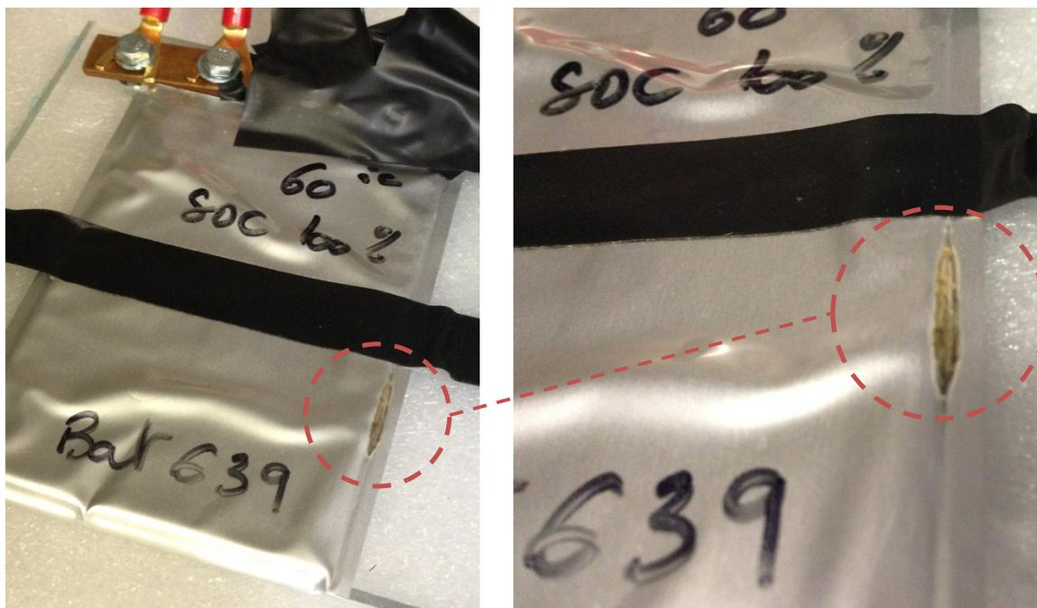
Figure 3-2. Clichés de la BAT639 stockée à SOC 100 % et 60 °C ayant subi un gonflement et une fissuration de son emballage.
