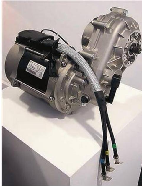
FIGURE 4.5 – Moteur asynchrone du véhicule Renault Twizy
