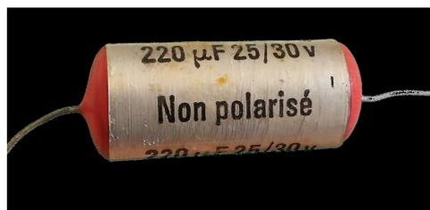
FIGURE 1.9 – Photo d'un condensateur électrolytique non polarisé
