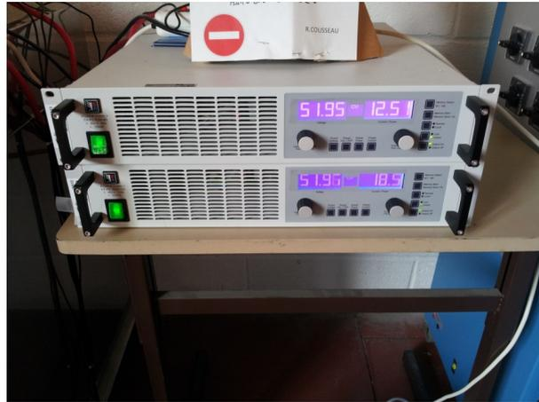
FIGURE 5.4 – Alimentations continues respectivement de 1.5 kW et 3 kW
