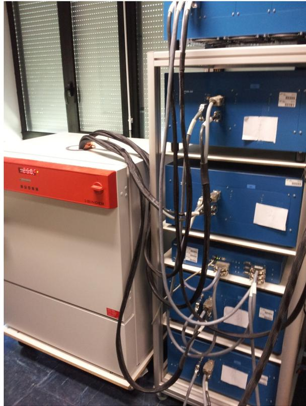
FIGURE 2.11 – Étuve permettant de maintenir en température les éléments mesurés et reliée avec le Biologic©
