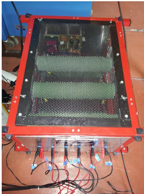
FIGURE 5.2 – Chariot avec les résistances de charge ( $2.5 \Omega$  pour 1 kW chacune)
