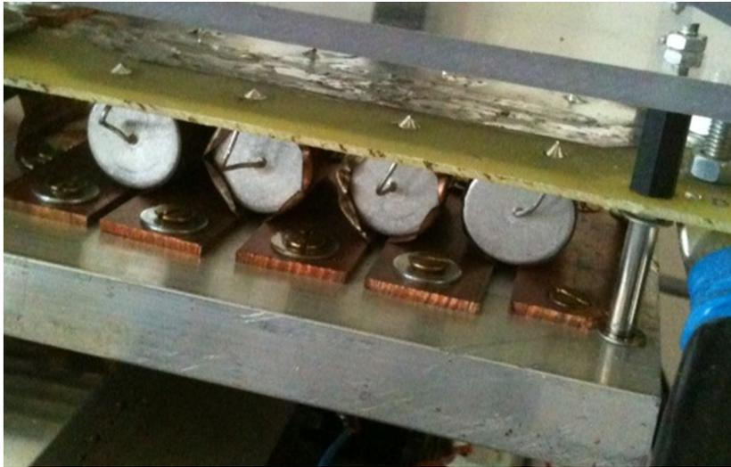
**Figure 5.1** – Les condensateurs chimiques sur le banc de test
