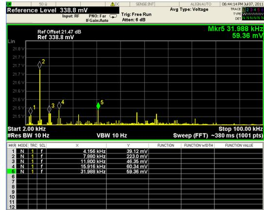
(b) SVPWM, spectre de courant dans les condensateurs
