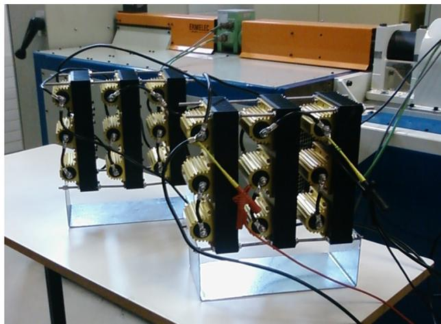
FIGURE 3.24 – Dispositif expérimental de l'essai sur système triphasé résistif
