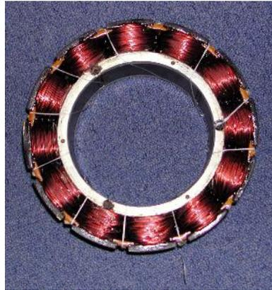
FIGURE 1.14 – Rotor de la machine synchrone à rotor bobiné développée dans le cadre d'une application alerno-démarrreur
