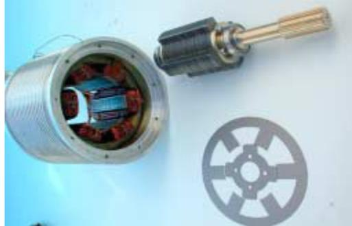
FIGURE 1.9 – Machine à réluctance variable [ALHASSOUN, 2005]
