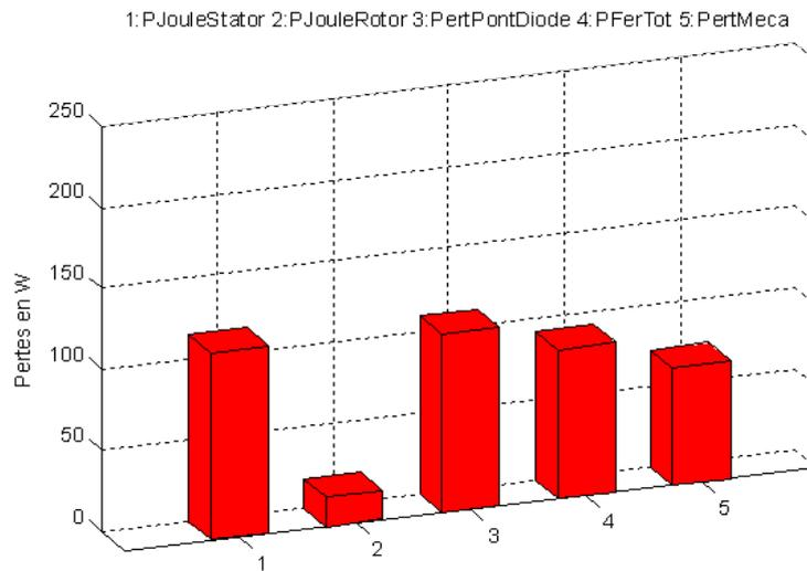
FIGURE 2.16 – Pertes séparées analytiques de l’alternateur "A" au cours d’un cycle VDA
