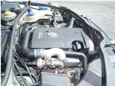
FIGURE 1.1 – Illustration de la compacité d'un moteur thermique moderne (TDI 110ch, VW)
