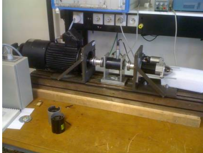
FIGURE 5.3 – Dispositif expérimental de séparation des pertes du démarreur
