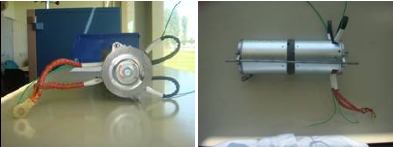
FIGURE 4.43 – Dispositif expérimental de mesure du courant de circulation inter-balais
