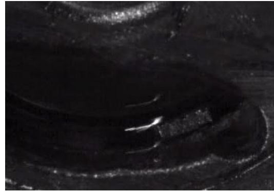
FIGURE 4.31 – Visualisation d'un arc lié au saut d'un balai d'un démarreur FS18
