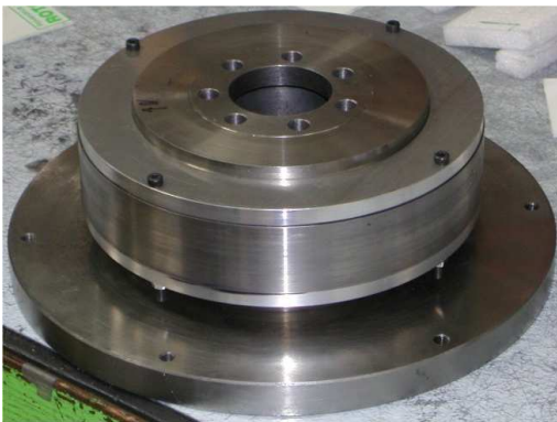
(d) Rotor de l'ADI avec flasque de protection
