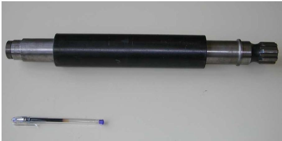
FIG. 1.6 – Rotor d'une machine à aimants permanents surfaciques
