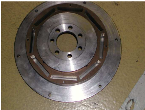
(b) Rotor de l'ADI sans aimant permanent
