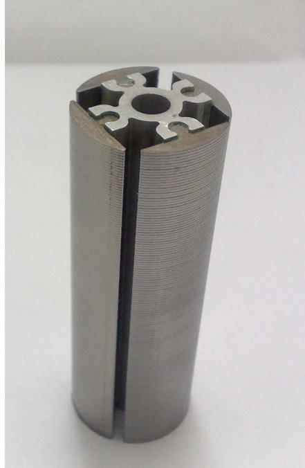
**Fig. 5.2:** Assemblage des pièces polaires du rotor
