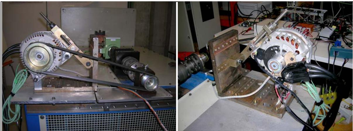
Figure V.18: Système de fixation de la StARS et réglage de la courroie d'entraînement.
