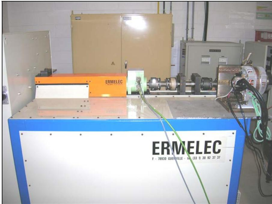
Figure V.20: Accouplement StARS- banc d'essais : vue d'ensemble
