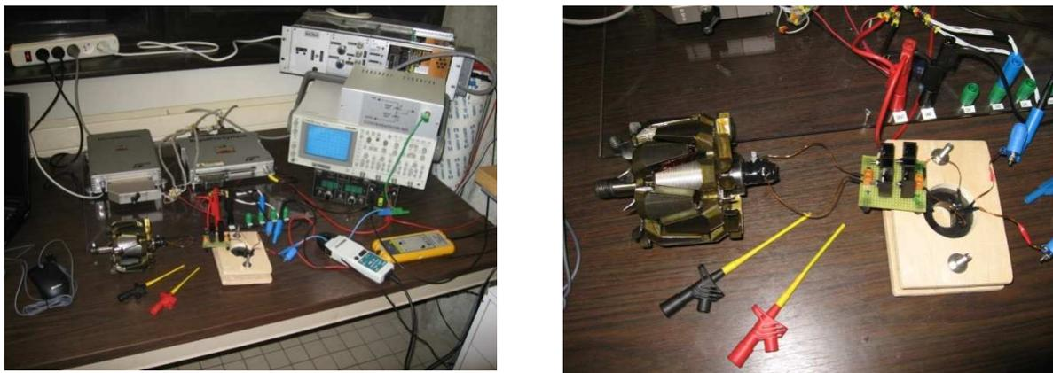
Figure III-27 : Transformateur tournant monté sur le banc d'essai Microautobox
