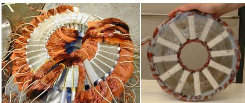
Figure I-48 : Différences entre un bobinage de type distribué (gauche) et concentré (droite)
