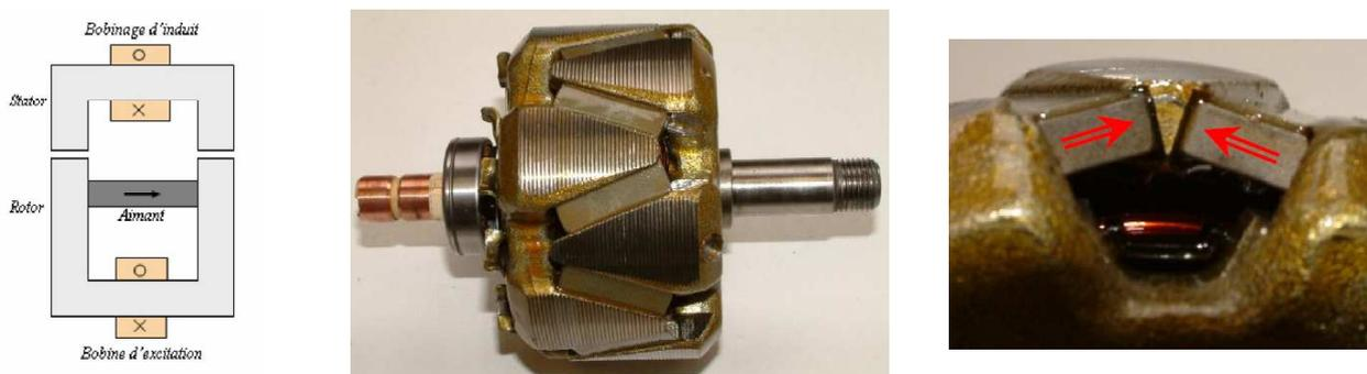
Figure I-35 : Schéma de principe d'une structure à double excitation parallèle de type 1 et rotor de machine à griffe
