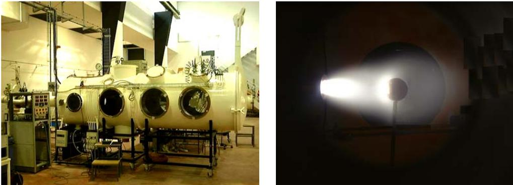
Figure 3 : 1 des 4 souffleries de la plateforme FAST et essais d'interaction plasma/objet
