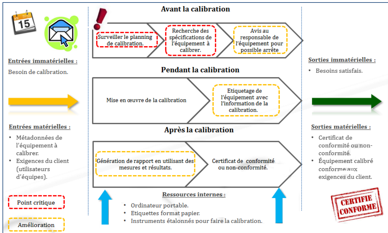
FIGURE 13: PROCESSUS ACTUEL DE CALIBRATION DES EQUIPEMENTS (7)
