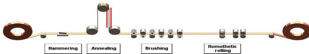
Process continu avec martelage, recuit, broyage, nettoyage et laminage de finition
