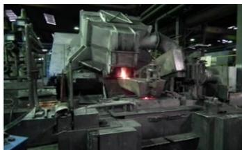
Griset possède des fours de fusion à induction, ceci pour couler principalement des lingots d'alliages de cuivre mais aussi des lingots d'aluminium (lorsque cette première étape n'est pas confiée aux fournisseurs).
