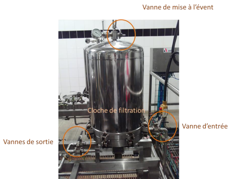
Figure 19 : représentation d'une cloche de filtration [4]
