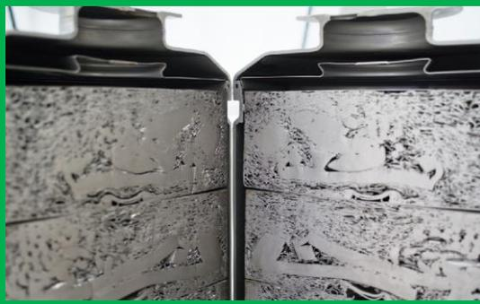
Figure 11 : container de type CSD/C contenant les coques et embouts des combustibles usés hautement compacté (source : intranet AREVA NC - établissement de la Hague).
