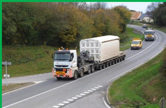
Figure 9 : transport de container TN85 appelé "château" contenant les combustibles usés des électriciens. Ces châteaux sont transportés par voie ferrée jusque Valognes (50) puis via un convoi exceptionnel jusqu'au site de la Hague (source : intranet AREVA NC).
