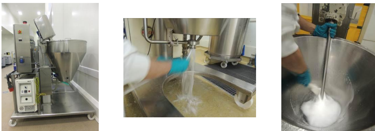
Figure 14: Présentation d'un fondoir mobile utilisé pour la production de produit de soins [source auteur]
