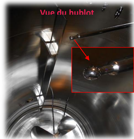
Figure 5 CIP, système de nettoyage d'un bioréacteur, [source auteur].
