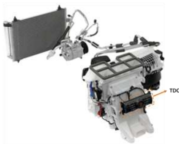
Figure 10: Module HVAC et TDC
