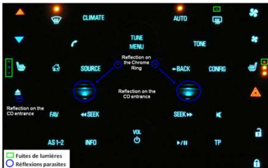
Figure 33: Colorimétrie et détection des défauts sur l'Opel Ampera.
