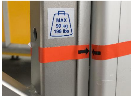
Figure 18 : Traçage pour réglage hauteur [Source : Auteur]
