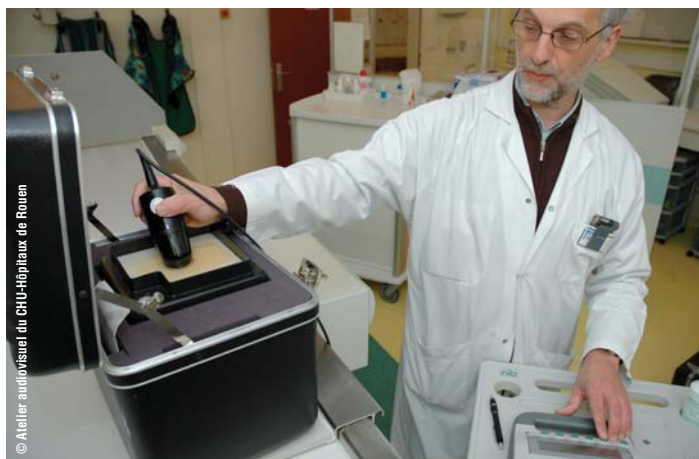
Technicien biomédical : Procédure de contrôle qualité d'un échographe urinaire.
