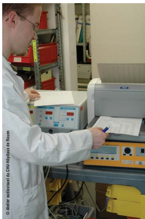
Technicien biomédical : Procédure de maintenance préventive d'un bistouri électrique.
