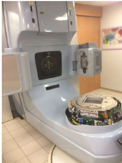
Figure 25: Bras du CLINAC IX soutenant le collimateur
