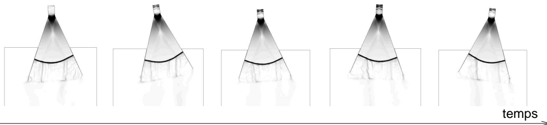
Figure 51 – Succession de Schlieren numériques pour un régime de couplage faible (lent) (amplitude imposée \theta_o = 8^\circ )
