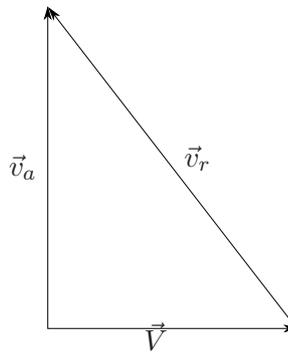
FIGURE 2 – Diagramme des vitesses pour le trajet le plus court en distance, cad  $\vec{v}_a$  est **vertical**.
