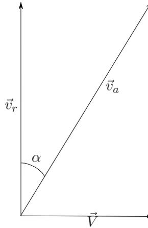
FIGURE 3 – Diagramme des vitesses pour le trajet le plus court en temps.
