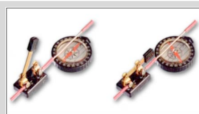
(a) En l'absence de courant dans le fil, l'aiguille de la boussole est dirigée vers le Nord. (Le fil a été mis parallèle à l'aiguille.) (b) Lors du passage du courant, l'aiguille est déviée par le champ magnétique créé par le courant.
