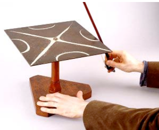
- Les vibrations de la plaque dues au frottement de l'archet sont matérialisées par des figures géométriques réalisées avec du sable. -
