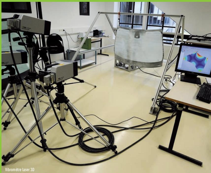
Vibromètre laser 3D
