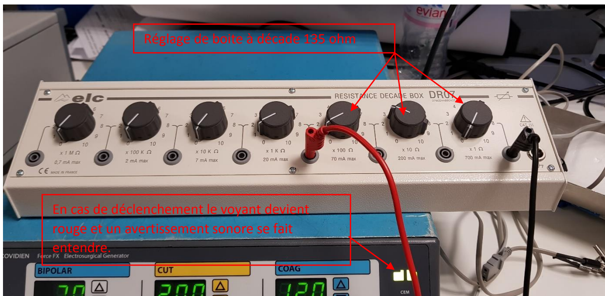
Figure 15 : Réglage boîte à décade (source auteur)
