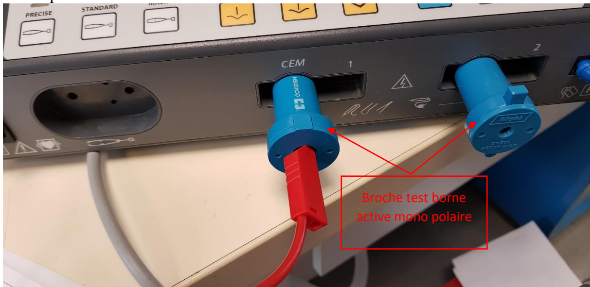
Figure 13 : Emplacement pour broche sur partie active (source auteur)
