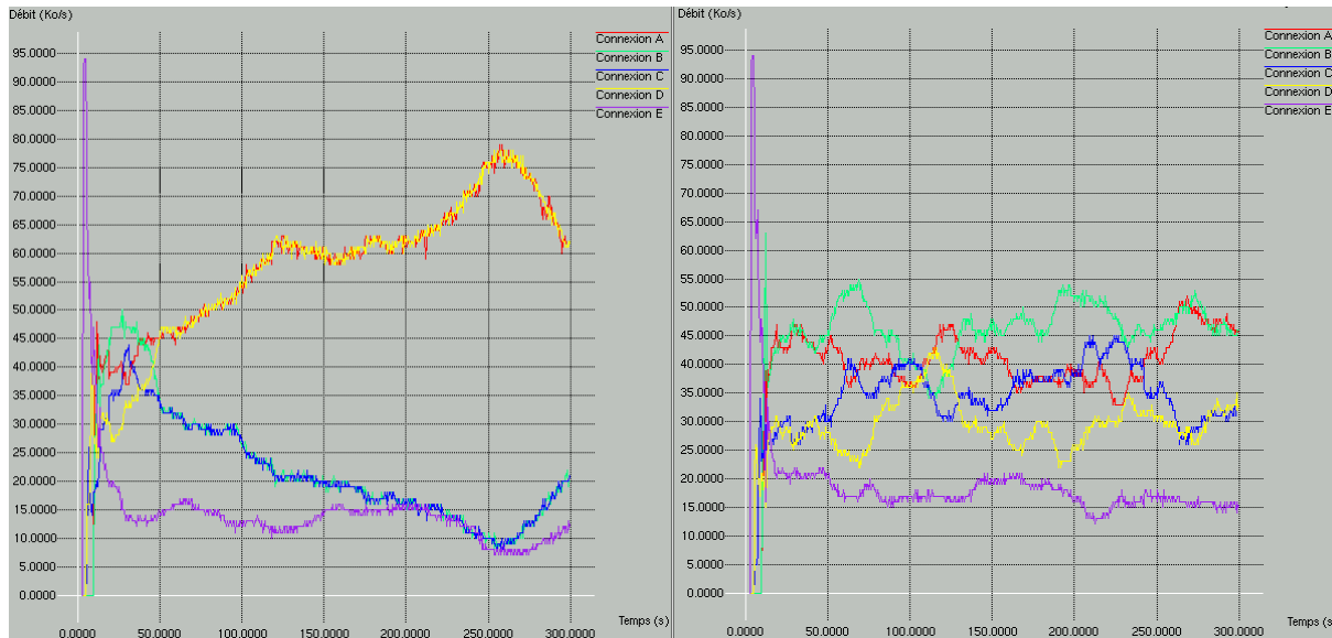
FIG. 6.19 – Dans la figure de gauche, les groupes de connexions E, C/D et A/B démarrent à 5 s d'intervalle, dans la figure de droite ces groupes démarrent dans le même ordre avec un intervalle de 5,1 s. Ces figures ont été obtenues en utilisant le protocole TFRC.
