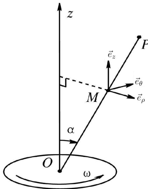
FIGURE 4 – Masse ponctuelle  $M$  sur une tige oblique en rotation uniforme.
