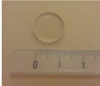
Figure 30 : Fenêtre  $\text{BaF}_2$
