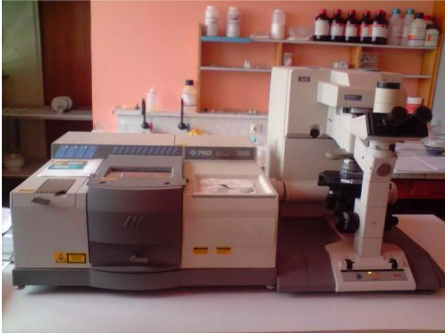
**Figure 29** : Spectromètre Nicolet Magna-IR 760 à transformée de Fourier équipé d'un microscope Nicolet NicPlan et d'un détecteur MCT-A de l'Institut des Sciences de la Terre d'Orléans (ISTO).
