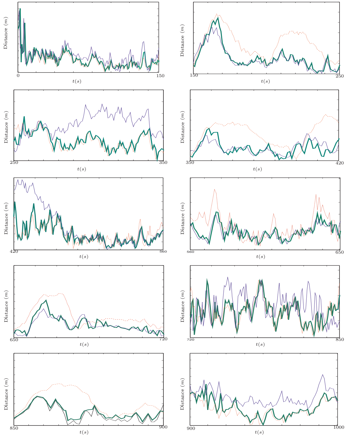
Figure 4.10 – Distances entre les valeurs estimées et exactes du véhicule pour la méthode BIMM (ligne en gras), la méthode FKE avec le modèle M^1 (ligne pointillée) et la méthode FKE avec le modèle M^2 (ligne continue).
